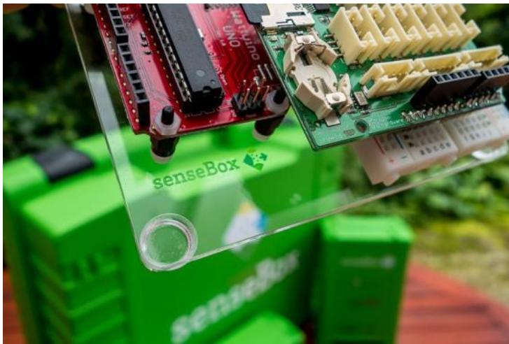
Die "senseBox" – ein Bausatz mit Sensoren zur Messung von Klimadaten; © WWU/ifgi
